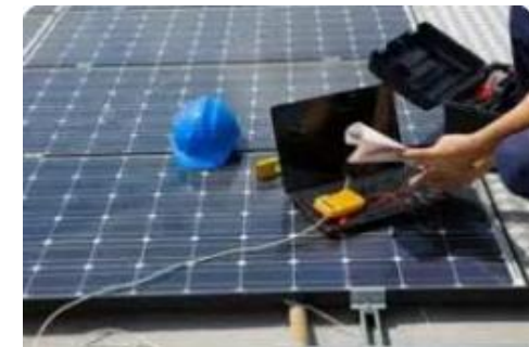
Fig.10.7. Mesure de la tension du panneau
