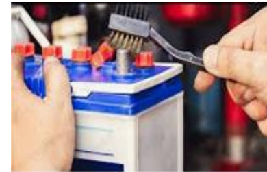
Fig.9.6. Entretien des batteries
